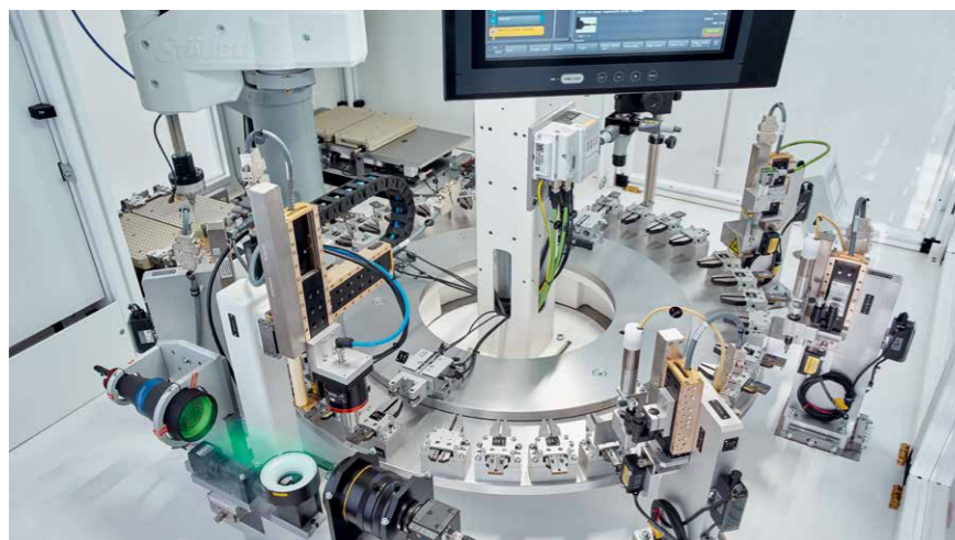
Rundtisch mit mehreren Mess- und Prüfoperationen
