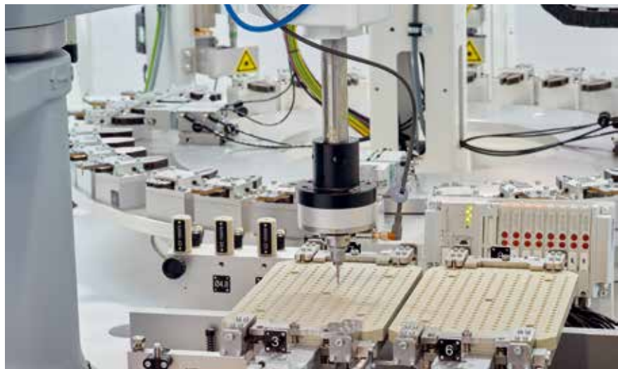
Beispiel einer Werkstückzuführung über Palette und Roboter
