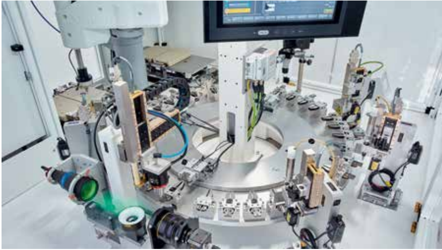
Rundtaktisch mit mehreren Mess- und Prüfoperationen
