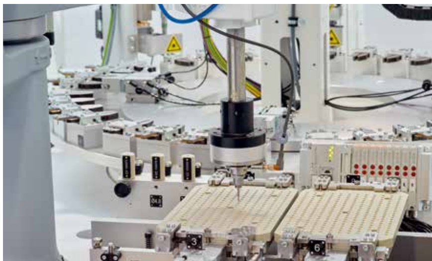
Exemple d'une amenée de pièce à usiner via palette et robot
