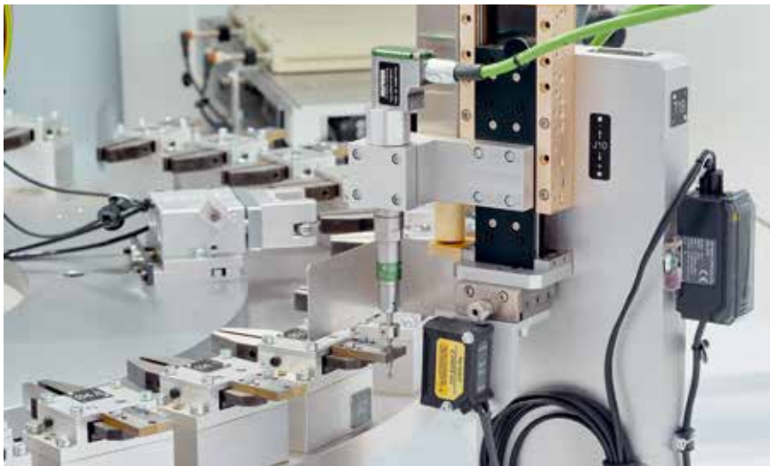
Test du couple et de la profondeur du taraudage
